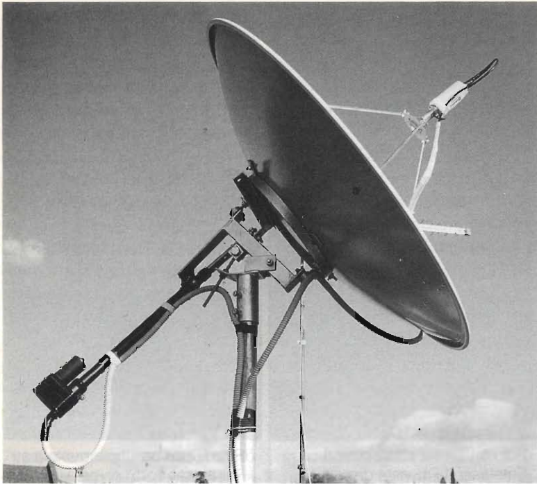
Foto 7 - La parabola montata e regolata pronta a funzionare. Si notino i fissaggi dei cavi e la sigillatura delle connessioni.
