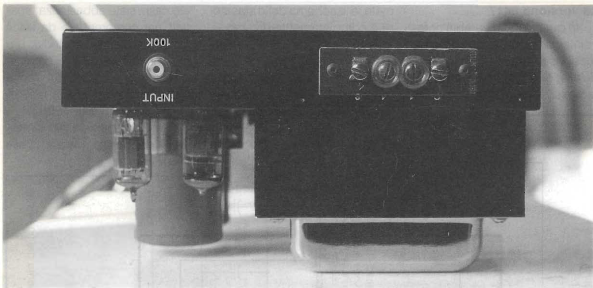
figura 6 - I morsetti di uscita e la presa RCA di ingresso. N.B.: la foto è giusta, è il finale che è appoggiato alla rovescia; attenzione alle valvole quando fate questo giochetto, sporgono dai trasformatori!
